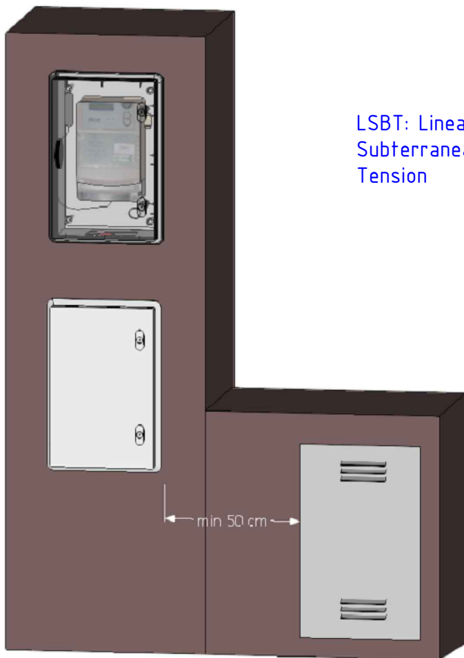
Distancia minima a instalaciones de gas
